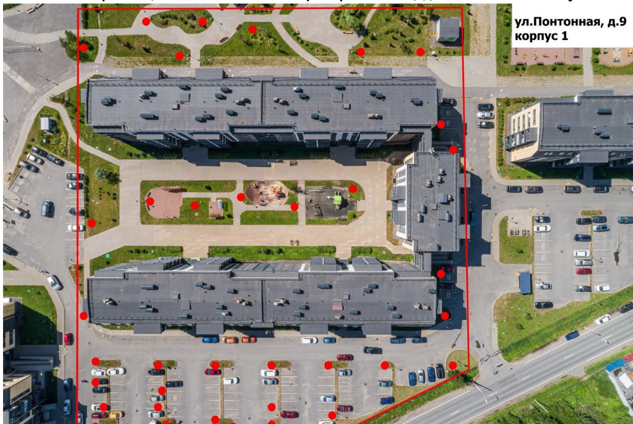
Схема размещения осветительных приборов на общедомовом земельном участке.
